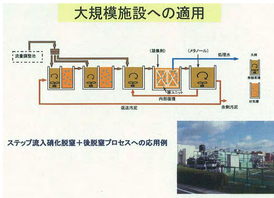
図 2.4 大規模 MBR（膜分離ステップ多段法）の開発状況 7)
