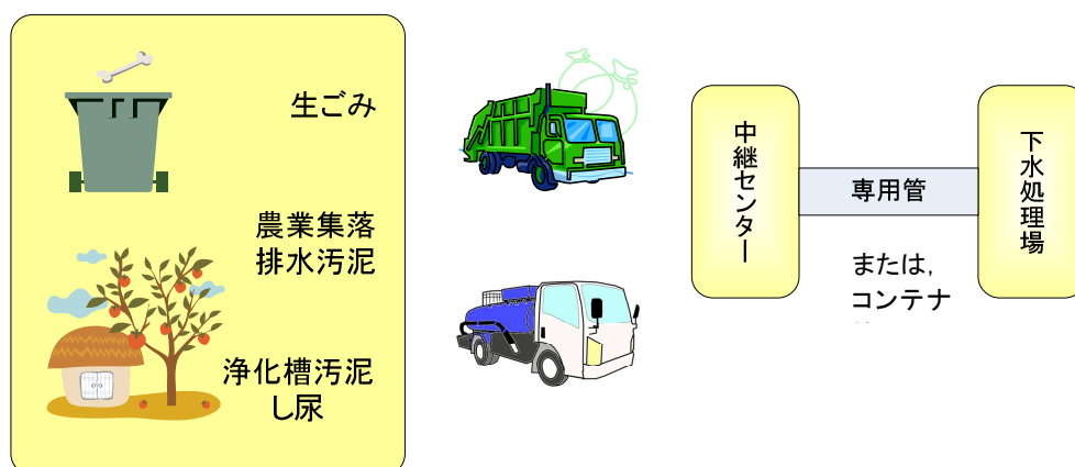
図４－３ バイオマス収集方法の概念図
