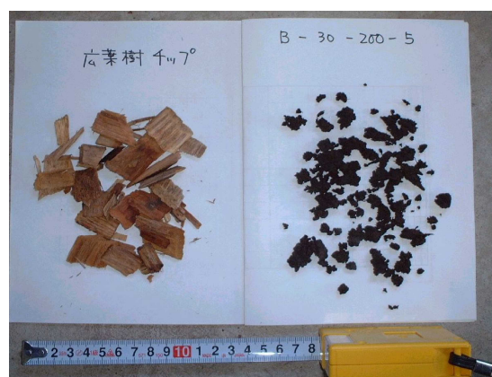
図3-11 広葉樹チップの蒸煮・爆砕処理例
