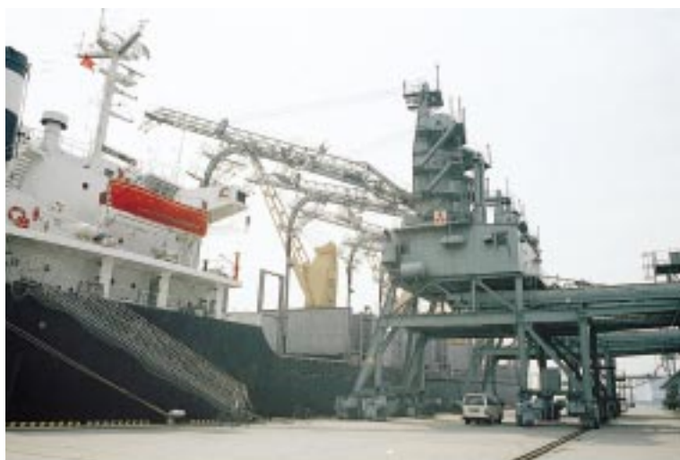
アンローダによる積卸し作業
